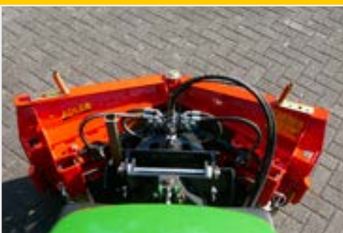
Alle Räummöglichkeiten in V-, Y- und Diagonalstellung
