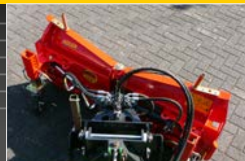
Hofladeraufnahme mit Niveaueingleich und Abstellstütze
