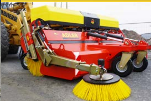
Hydraulisch klapp- und zuschaltbarer Seitenkehrbesen (Ø 900 mm).
