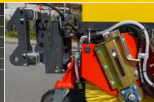
Radladeraufnahme mit Niveaueingleich über Rollenführung
