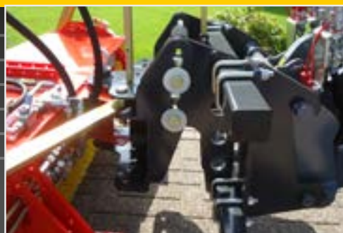
Hofladeranbau mit 3D-Niveaueingleich
