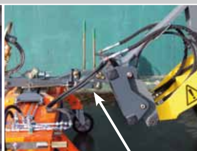
Hof- / Frontladeranbau mit Parallelogramm und Pendelausgl. inkl. Höhenanzeige
