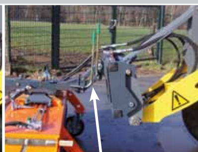
Hof- / Frontladeranbau mit Parallelogramm und Pendelausgl. inkl. Höhenanzeige
