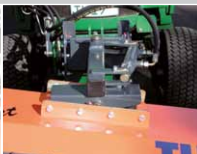
doppelter Niveaueingleich mit hydraulischer Seitenverstellung
