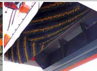
V-förmig angeordnete Spezial-Kehrwalze, für Fein- u. Grobschmutz
