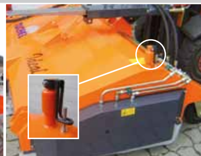
Handkurbel zum Einstellen der pendelnd aufgehängten Kehrwalze
