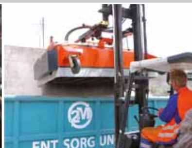
hydraulische Entleerung des Sammelbehälters, serienmäßig
