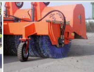
einfache Bürstennachstellung über Rasthebelsystem
