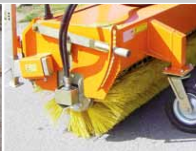
zwei leistungsstarke, innenliegende Motoren für den Bürsteantrieb
