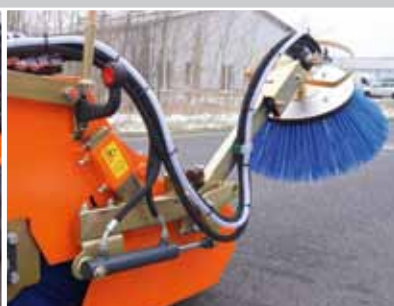
hydraulisch klappbarer Seitenkehrbesen
